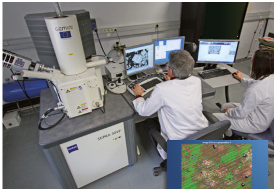
Microscope Electronique à Balayage couplé analyse EDS avec cartographie des éléments
